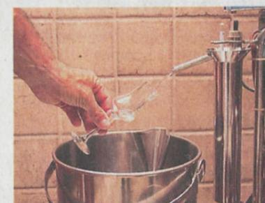
Ist der Brenner auf Betriebstemperatur, dauert es nicht lange, bis der erste Strahl des klaren Destillats aus dem Mittellauf tritt.
